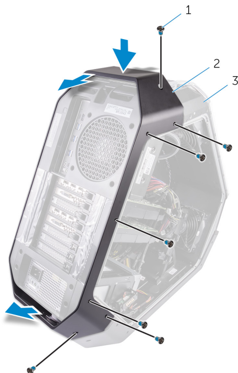
Рисунок 55. Снятие задней ручки
