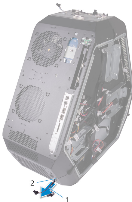
Рисунок 79. Извлечение кабелей нижней подсветки Tron
